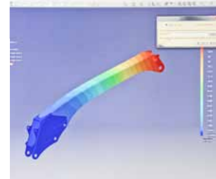
Finite Elemente Simulation: Belastung des Hubarms
