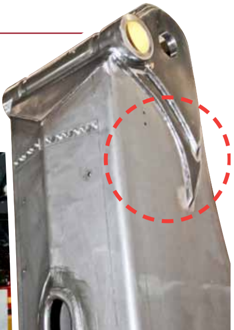
Gezielte Verstärkung mittels zusätzlicher Blechlagen entlang der Lastpfade
