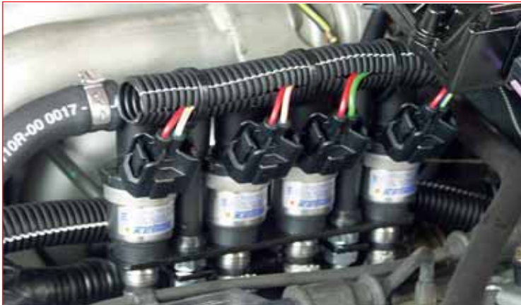
Die Einspritzdüsen regeln elektronisch gesteuert den Gasfluss
