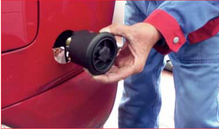
Fürs Tanken von Gas wird ein zweiter Einfüllstutzen montiert
