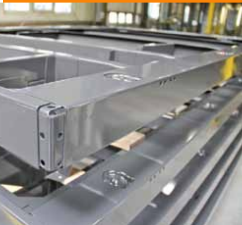
Die lackierten Rahmen vor den Einbau des Bodens. Anschließend folgt die Montage der Beschlagteile
