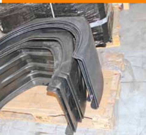
Die Kotflügel sind nach der „Hochzeit“ der Pritsche mit dem Fahrgestell zu montieren
