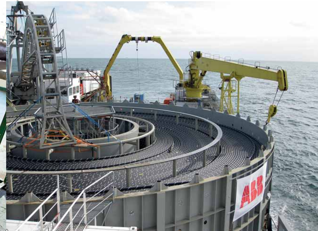
Anschluss auf hoher See: Die insgesamt fünf notwendigen Verbindungen zwischen den Teilstücken des Kabels müssen auf dem Schiff erstellt werden. Einmal schlich sich bei dieser Prozedur ein Fehler ein, der später zu einem vorübergehenden Ausfall der Leitung führte
